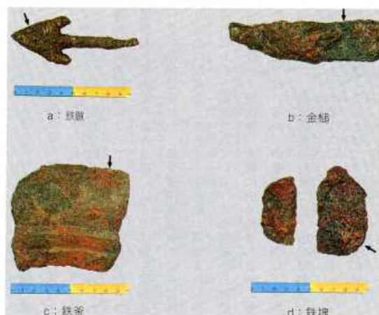
図78 分析を行った鉄器の外観(矢印は分析試料抽出位置)
